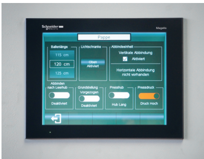
Touchscreen-Display zum Einstellen für individuelle Materialparameter
